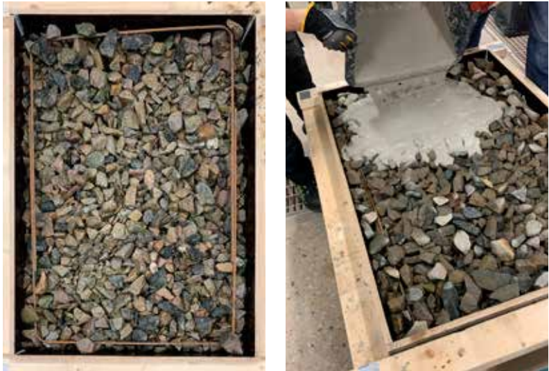
Figur 1. Tillverkning av platta av cementbunden makadam. Tvättad makadam 32–64 mm läggs ut i önskad tjocklek (vänster); makadamen infiltreras med lättflytande bruk (höger).
