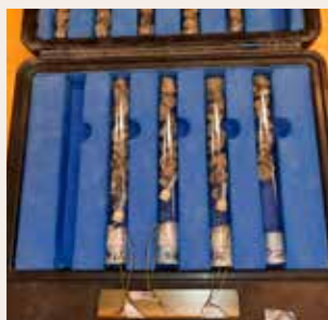
3. HG-givare i provrör med krossad betong. Provrören placeras i en väska med isolering.
