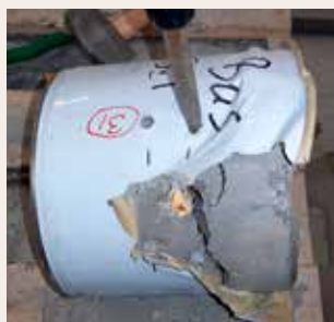
2. Hinken spräcks kontrollerat i skivor genom att förborra.
