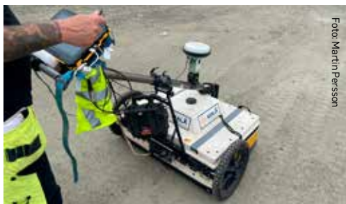
Klassning av marken, med hjälp av georadar, i ett varvsområde som ska exploateras.
