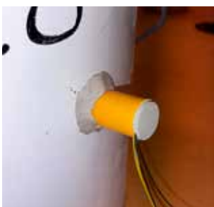
1. Borrhålsmätning med tätning mot plåt.
