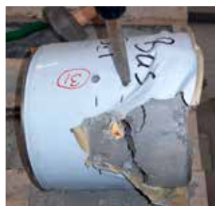
2. Hinken spräcks kontrollerat i skivor genom att förborras.
