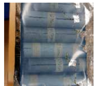
4. Efterkontroll av läckage i 100% RF.
