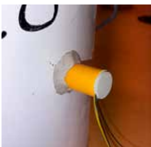
1. Borrhålsmätning med tätning mot plåt.
