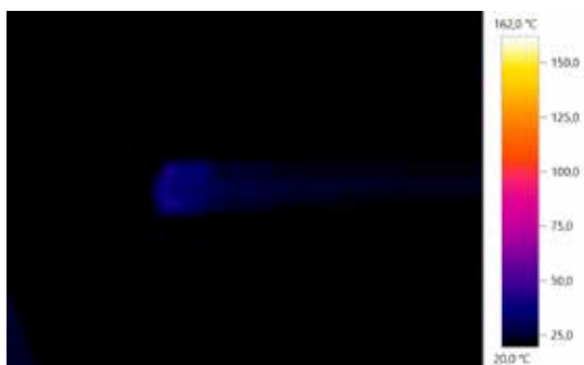
Figur 4. Temperaturen på borrets spets fångad med IR-kamera efter borrning av ett hål. Medan det traditionella borret drar iväg över 150 grader så stannar det ventilerade under 50.
