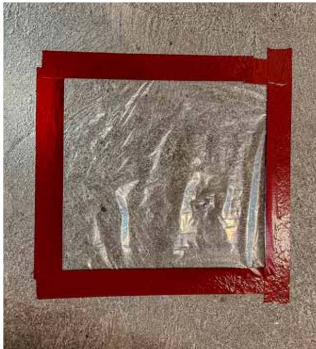
Folietest. En byggfolie med måtten 0,5×0,5 m tejpas över betongen. Finns kondens under plasten efter 16 timmar behöver betongen torka mer.
