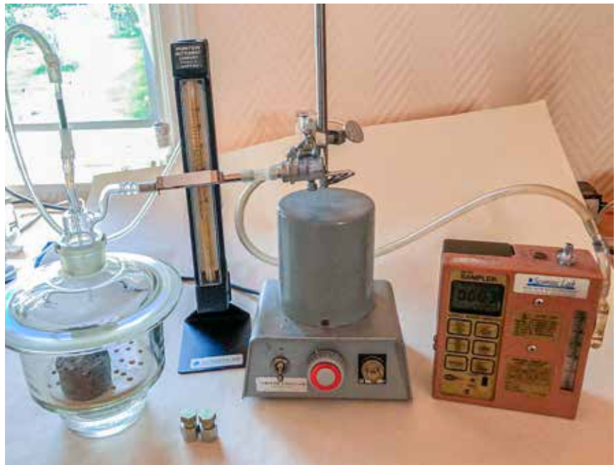
Figur 1. Mätuppställning för kammarmetoden med uttaget prov.
