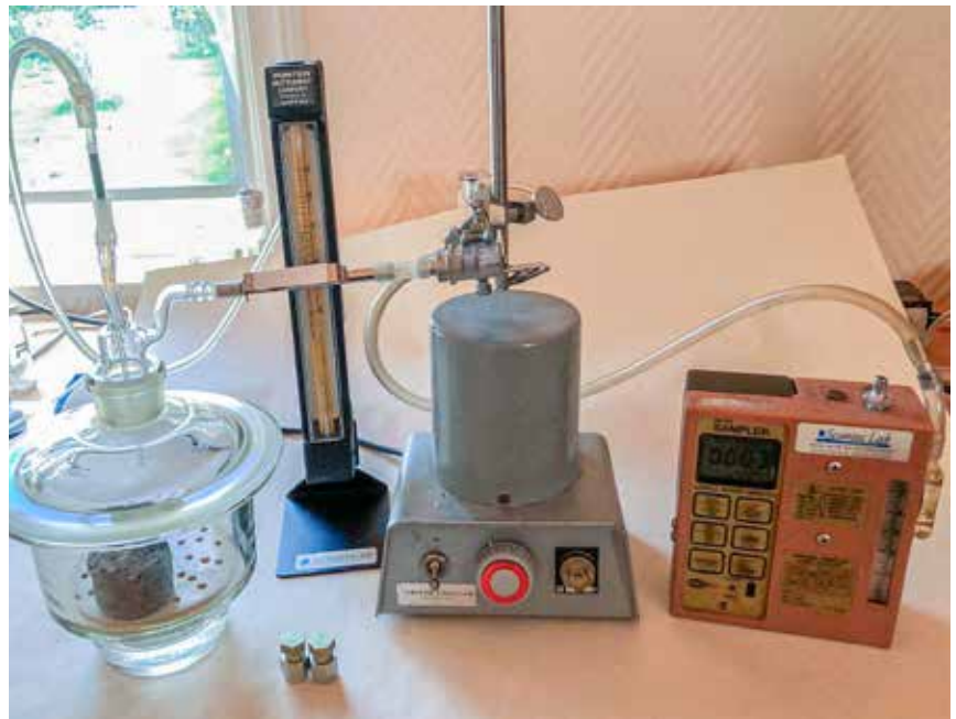
Figur 1. Mätuppställning för kammarmetoden med uttaget prov.
