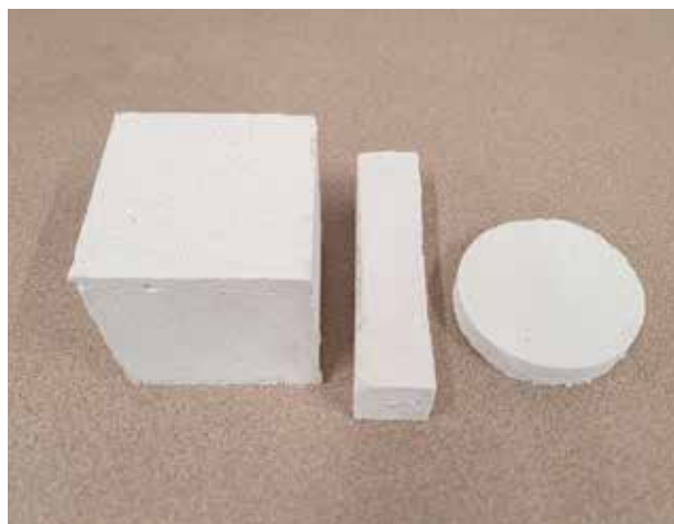
Provbitar av den superisolerande putsen för analys i laboratoriet på Chalmers.
