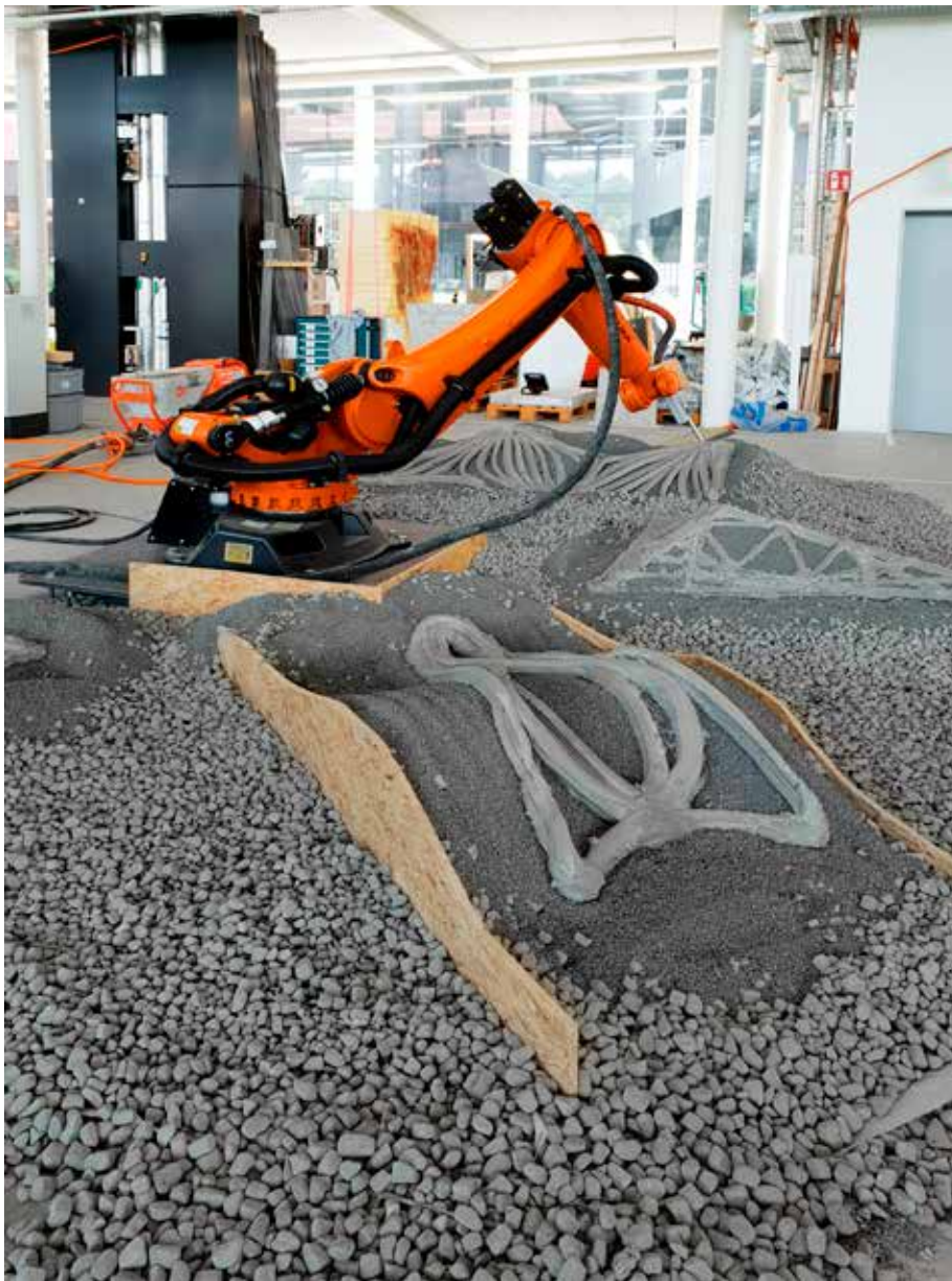
3D-printing av dubbelkrökta betongstrukturer. Roboten skapar först önskad topologisk form på grusbädden och printar sedan betong ovanpå. [RobArch 2018, ETH Zürich].
